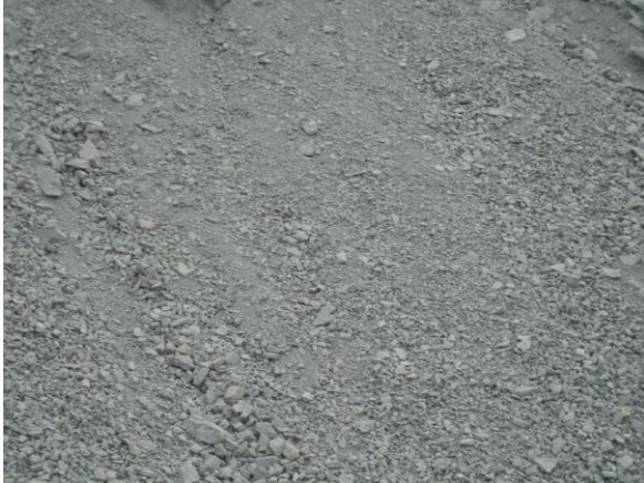
图一 较细的入磨物料 Fig.1 small Feeding Material
